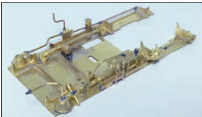
Sestavený rám a podlaha budky prototypového modelu s jednotlivými dílci brzdového systému a napáječů.
