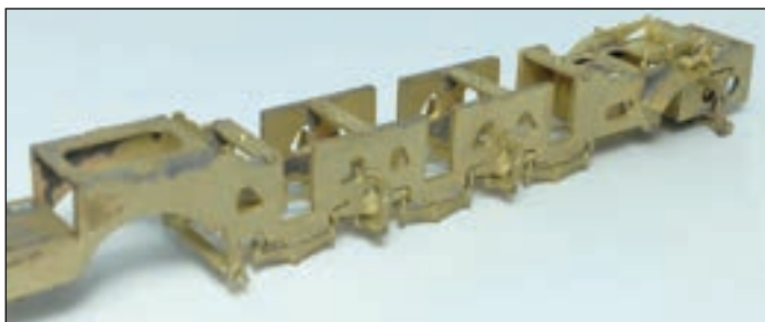
Sestavený rám a podlaha budky prototypového modelu s jednotlivými dílci brzdového systému a napáječů.
