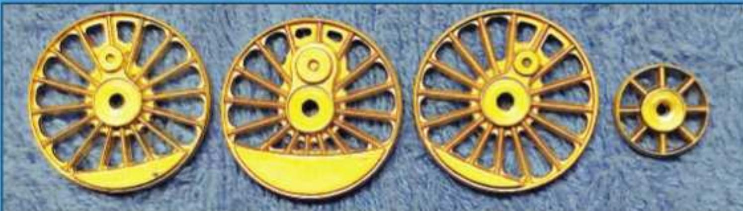
Pro výrobu paprskových kol je vždy potřeba navrhnout a odladit speciální nářadí, jež umožní výrobu hvězdic zobrazeného vzhledu. U „papouška“ to jsou dva typy hvězdic spřažených dvojkoli, hnacího dvojkolí a kol obou běžných podvozků. Před nalisováním na nápravu budou kola opatřena obrubcem profilu RP25 z nerezové oceli.
