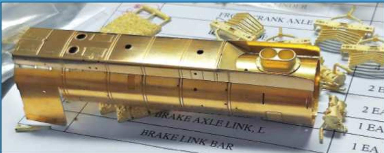
**Výbec první zakružený obal kotle s dosazenou nástavbou a odlitkem komínu. U prvních kusů dochází ke kontrole sestavitelnosti a návrhu přípravků pro sériovou výrobu.**
