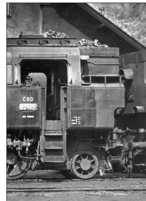
Jednotné provedení nástavby uhláku
